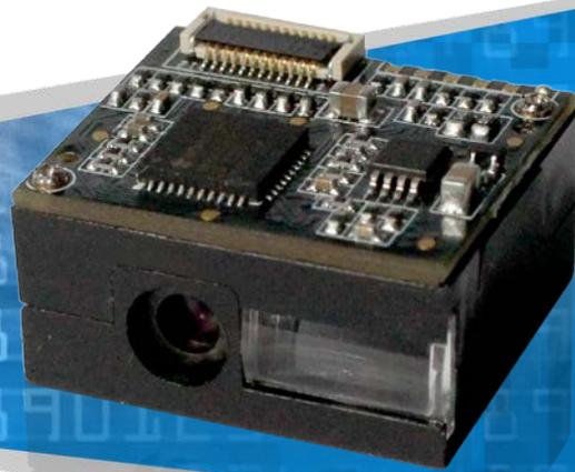
NLS-EM1395-LD 条码识读引擎专为客户提供的 OEM 产品应用，该款高性能 CCD 识读引擎可方便嵌入各种设备作为条码的识读组件应用，如展示亭、检票机、PDA 等。
