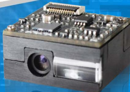
EM1395一维条码识读引擎专为客户提供的OEM产品应用，该款高性能CCD识读引擎可方便嵌入各种设备作为条码的识读组件应用，如展示亭、检票机、PDA等。
